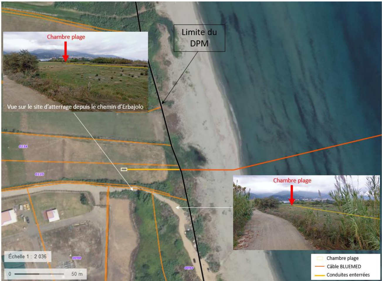
Figure 3 : Parcours du câble BLUEMED depuis la limite plage/mer jusqu'à la chambre plage située hors du DPM
