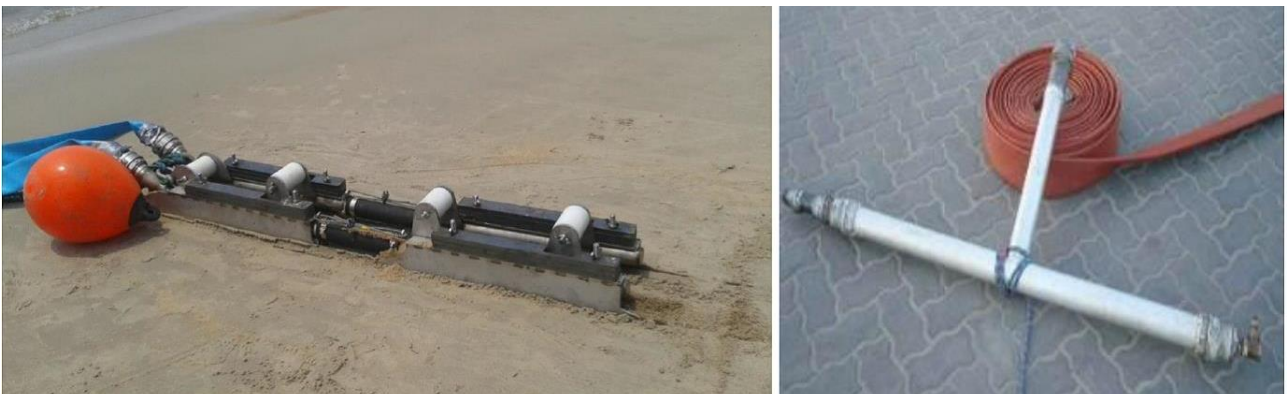
Figure 32 : « Jet sledge » de type WORM pour les eaux très peu profondes (à gauche), lance à eau d'ensouillage (à droite) (source : Orange Marine)
