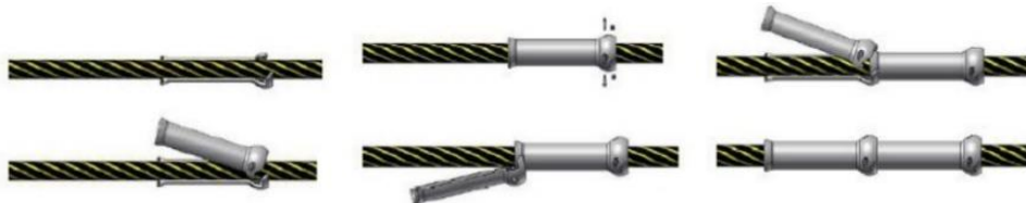
Figure 29 : Procédure d'installation des coques de protection sur le câble
